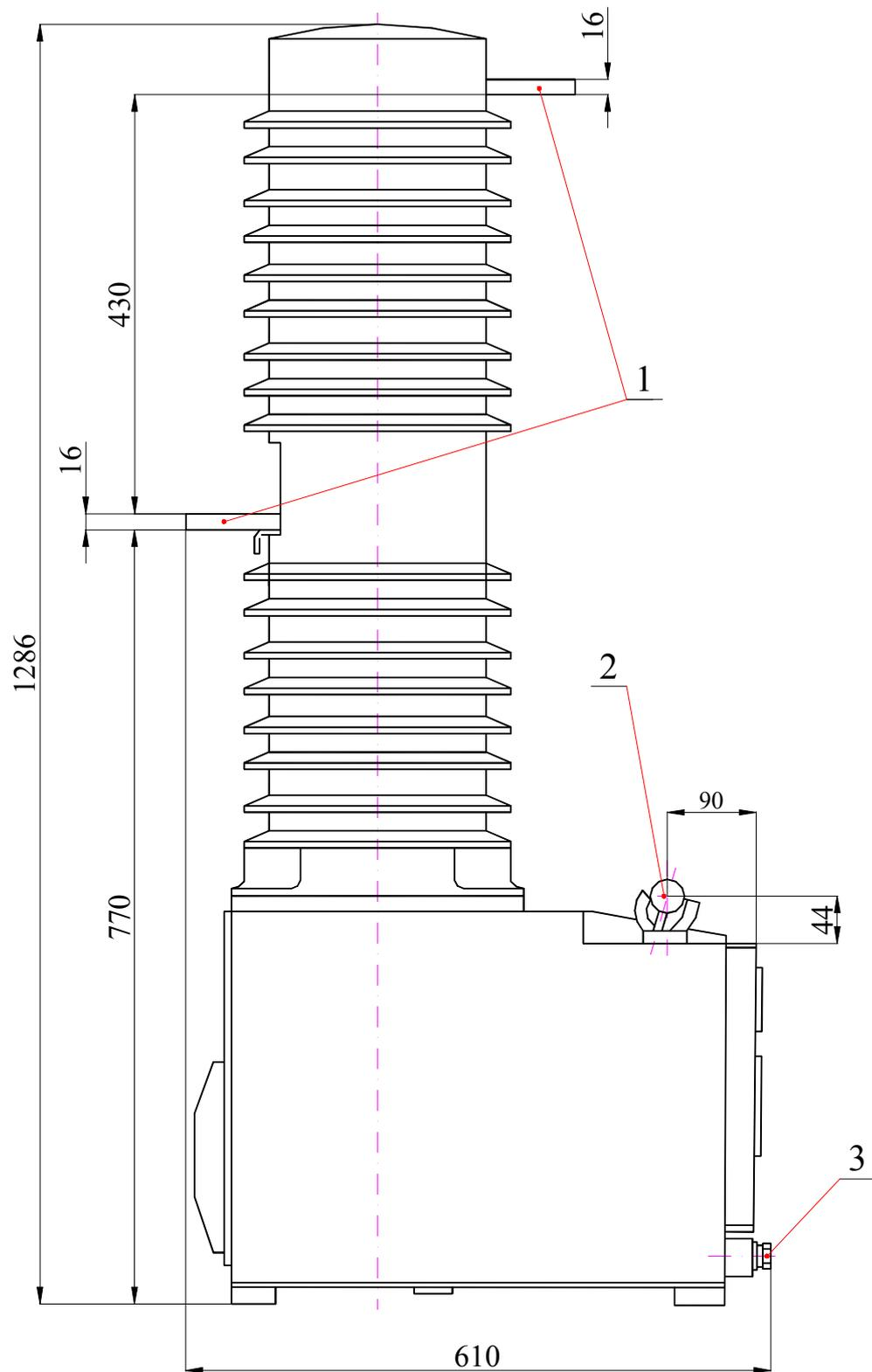
1—шина; 2—ручка ручного оперативного отключения, 3—болт заземления
