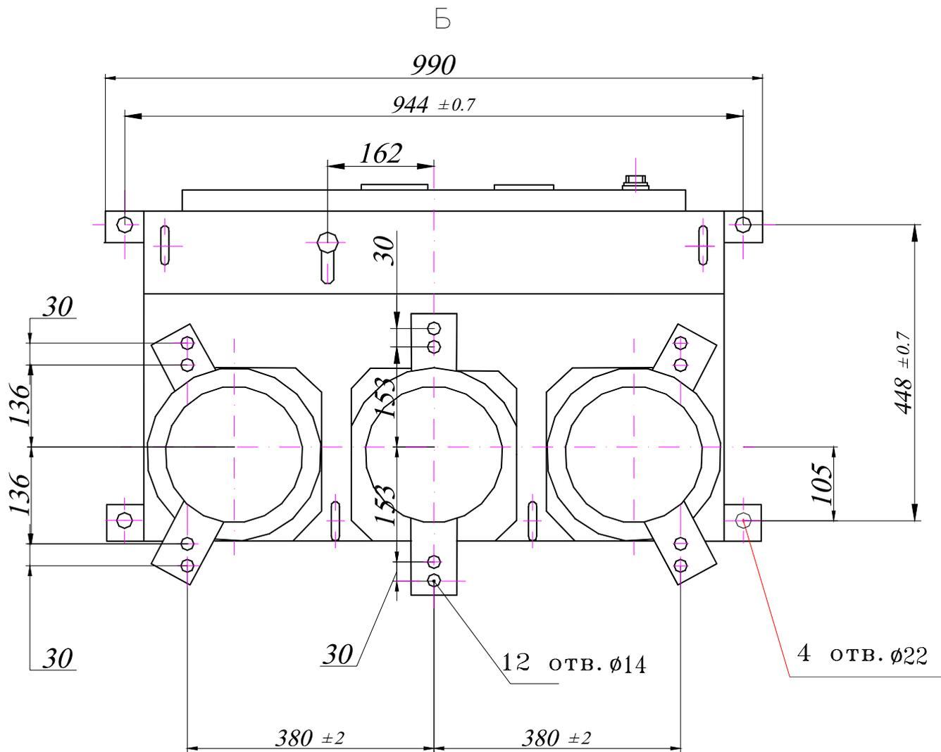
Рисунок Б.3 Габаритные, установочные и присоединительные размеры выключателя (вид сверху)
