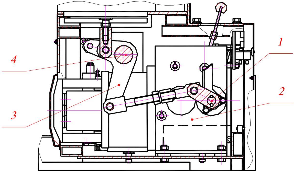
1–вал привода; 2–привод; 3–система рычагов; 4–вал выключателя
