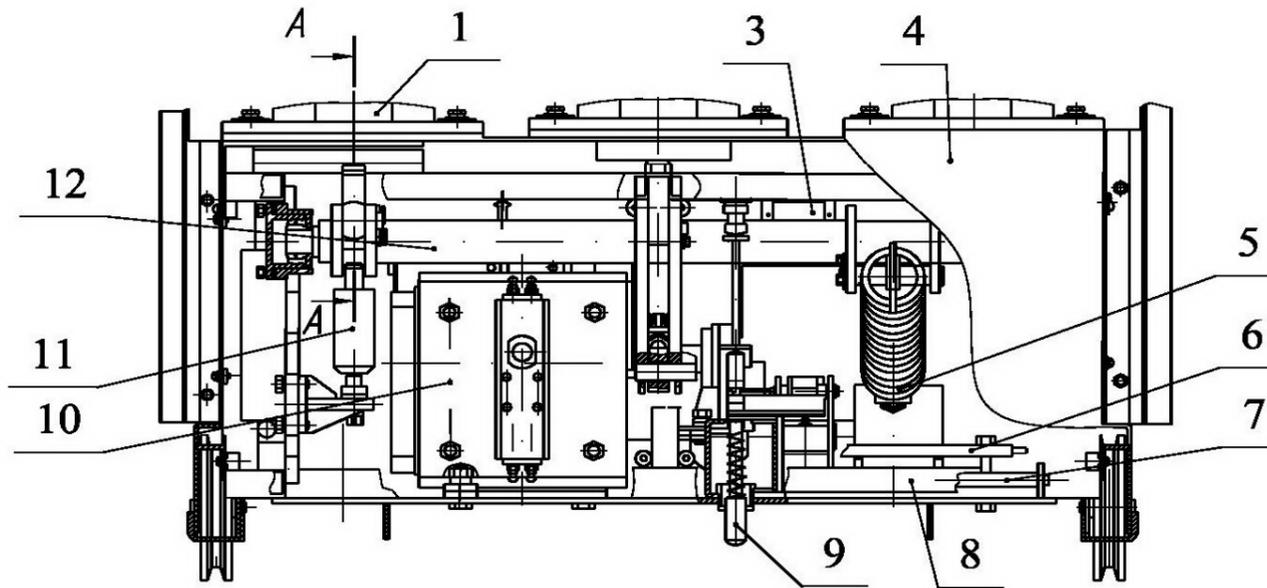
1-блок дугогасительный с КДВ (полос); 3-счетчик циклов; 4-крышка; 5-пружина отключения; 6-подогреватель; 7-антиконденсатное подогревательное устройство; 8-каркас;
