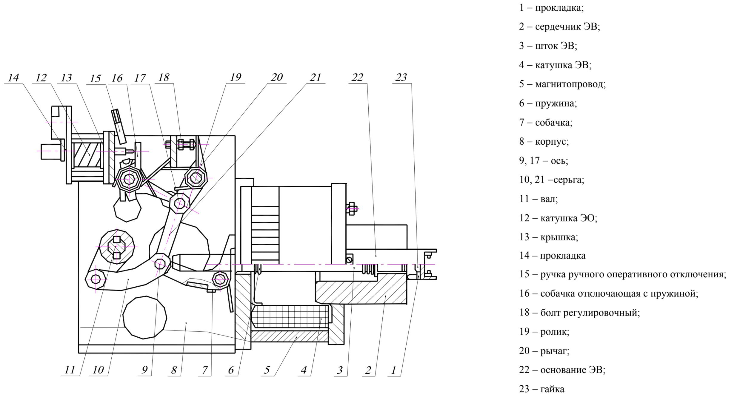
Рисунок Г.1 Электромагниты привода ПЭМУ
