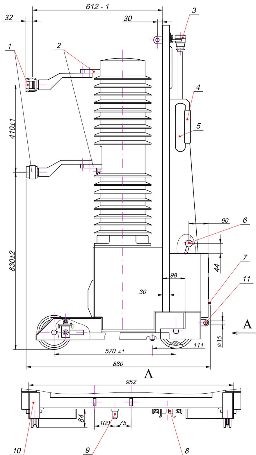
1—контакт; 2—шина; 3—жгут; 4—ручки; 5—отверстия для строповки; 6—тяга с ручкой местного оперативного отключения, 7—педаль рычага; 8—заземляющий зажим; 9—шток; 10—тележка; 11—отверстие для приспособления докатывания выключателя в ячейку КРУ
