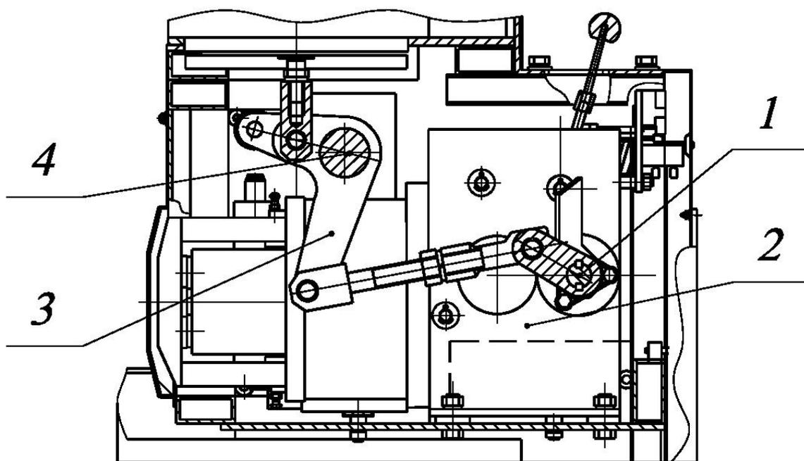
1-вал привода; 2-привод; 3-система рычагов; 4-вал выключателя
