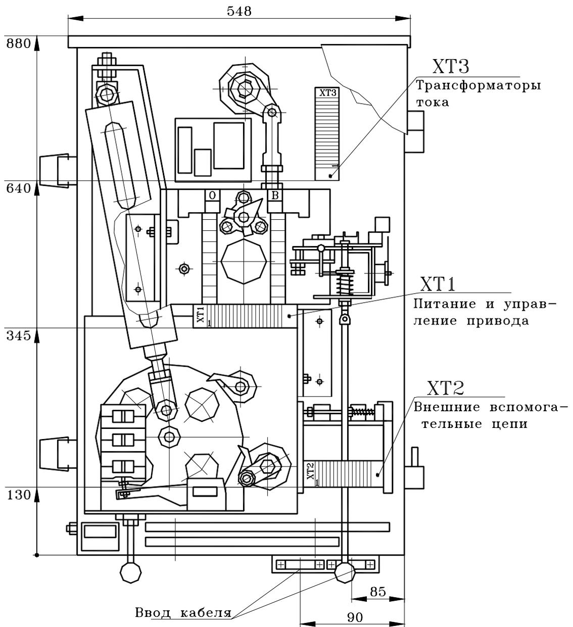
Рисунок 3 - Расположение клеммных колодок
